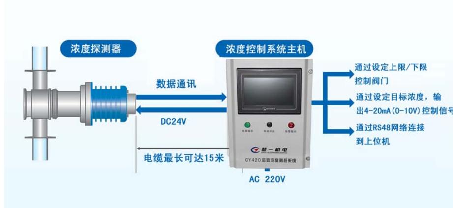
图 乳化液浓度在线测控系统（在线浓度计）结构示意图
