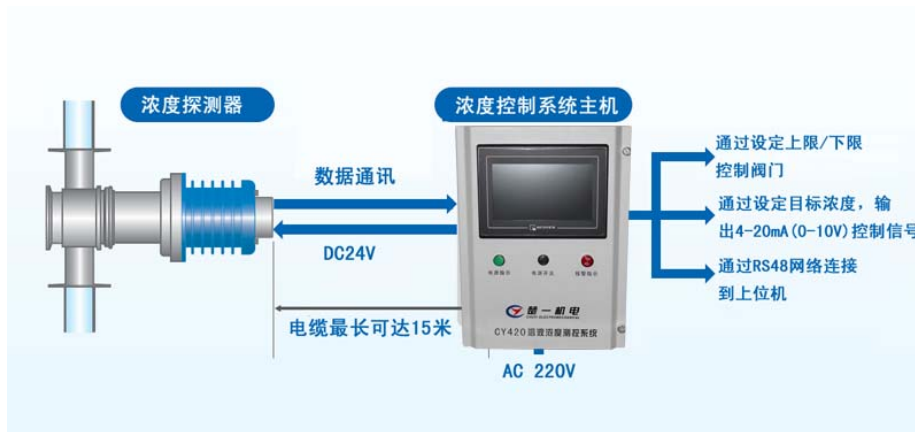
黑液浓度在线测控系统（在线浓度计）结构示意图
